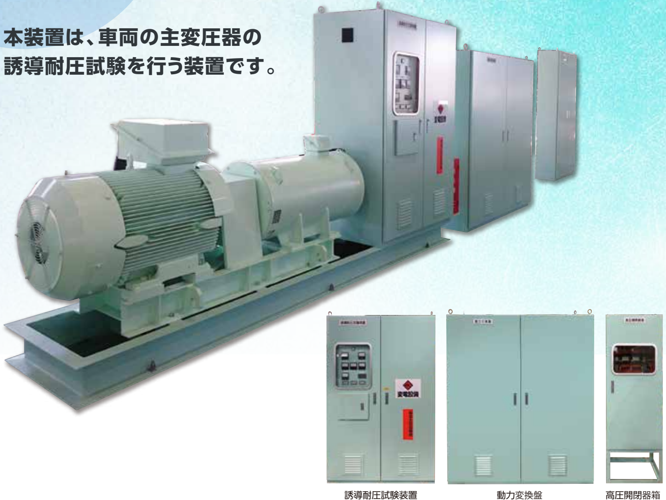
誘導耐圧試験装置
